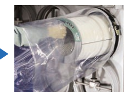
バグアウトカラー（標準装備）に袋を取り付けて汚れたフィルターを引き抜く
